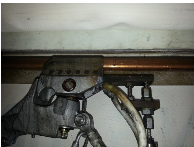
als Sprüher umgebauter Stromabnehmer
