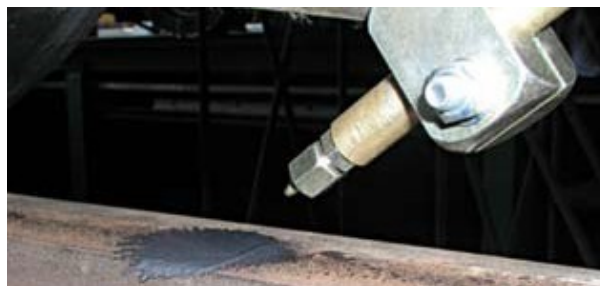
Buse de pulvérisation pour le traitement du champignon de rail.
